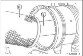
D. Primärelement E. Sekundärelement
