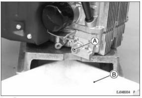
A. Ölablassschraube B. Geeigneter Behälter
